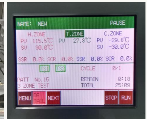
ภาพการทดสอบเม็ดพลาสติก PP recycle สูตรของ FPI ที่อุณหภูมิติดลบ 40^{\circ}\text{C}
