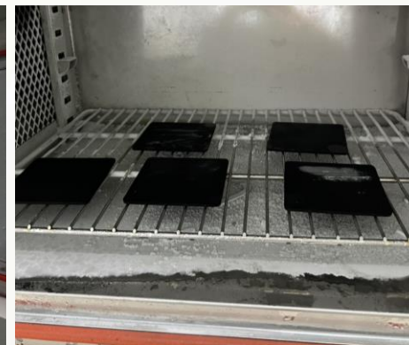
ภาพการทดสอบเม็ดพลาสติก PP recycle สูตรของ FPI ที่อุณหภูมิติดลบ 40^{\circ}\text{C}
