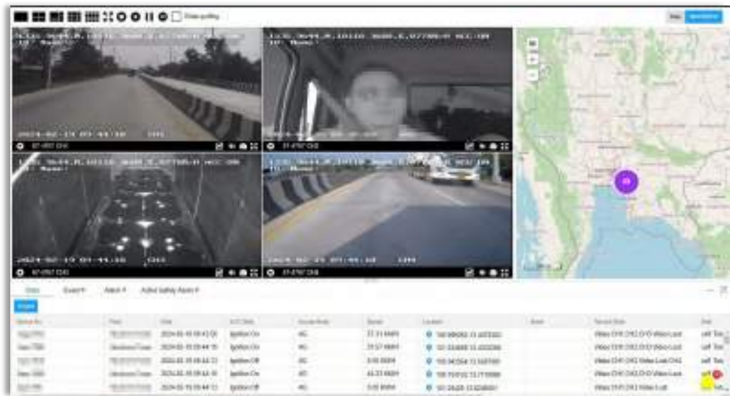
หน้าจอระบบ Telematics & AI Camera (ADAS and DMS)
